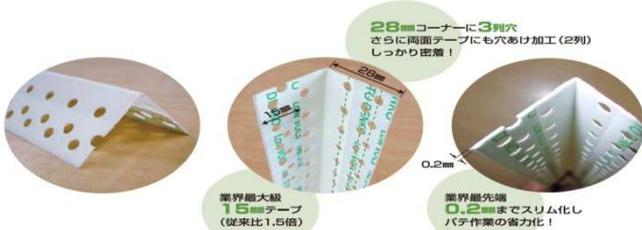
フクビ化学工業は5月1日、壁紙のコーナー補強材「コーナーラインシリーズ」から先端部を業界最薄にし石膏ボードへの密着性を高めた「Vコーナーライン スリムP-28TRS」を発売した。先端の厚みを0.2ミリにスリム化することでパテ作業を省力化。さらにテープ幅を広げ、穴あけ加工を従来の2列から3列に増やすことで下地(石膏ボード)にしっかり密着するようにした。これを使うことでコーナー先端の浮きを解消、壁紙の仕上がり向上ができる。440円/本(2.5m)、4万4000円/ケース(100本入り)。
