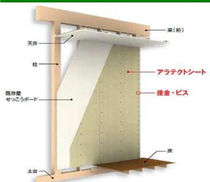
LIXILは既存壁を生かした耐震改修を可能とするリフォーム工法「アラテクト」を開発した。アラミド繊維を用いたシートで壁の耐力を上げる。新工法は橋脚の補強などに利用されるアラミド繊維に樹脂を含浸させ厚さ1mm以下のシート状に加工した専用部材を使用する。既存の室内壁の上から専用の座金・ビスで固定する。シートはカッターなどで簡単に切れる。1981年以降に建てられた石膏ボード直張りの建物が主なターゲット。大がかりな工事が不要で、住みながら簡単に工事ができる。通常耐震改修工事の5~6割程度で実現できるという。柱が105mm角以上の壁に施工した場合の壁基準耐力は、大壁仕様の一般壁で5.3kN/mと構造用合板と同等。大壁仕様・入隅壁で4.9kN/m、真壁仕様は一般・入隅壁ともに4.8kN/m。一般財団法人日本建築防災協会(建防協)の技術評価を取得済み。設計・施工にはLIXILの行う技術講習の受講が必要。同社は4月から全国13会場で技術講習を展開する。
