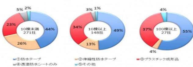
バルコニーでの出隅、入隅などの角部で採用している防水材の種類を教えてください。
