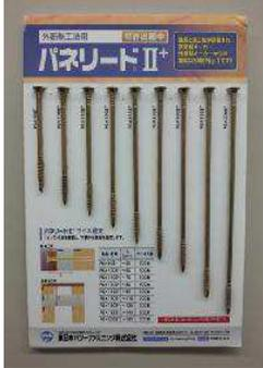
東日本パワーファスニングは、外張り断熱工法用のビス「パネリード II+」を販売している。外張り断熱工法では、柱の外側に断熱材がくるので、外壁下地の胴縁までの距離が長くなり、ビスにかかる荷重が大きくなる。「パネリード II+」は、この荷重に耐えられる性能を持つビスとして開発した。十分な長さ、太さ、強度を備え、特殊な先端加工により木割れが生じることもない。また、外壁や断熱材のサイズに合わせて個別にビス留めピッチを算定することができ、外壁の垂れ下がり防止する最適のピッチを選ぶことができる。表面にはクロメートという凹凸が少なく耐食性を高める表面処理を採用している。さらに、その上から TORK というコーティングを施すことで、打ち込み時にネジが受ける摩擦を30%以上低減させている。販売開始以来20万棟以上という納入実績が、「パネリード II+」の性能と施工性への評価を示しているといえるだろう。現在は、合板サンドイッチパネル留めや、仕口木材同士を締結するためにも使用しており、外張り断熱工法以外での活用も広がっている。
